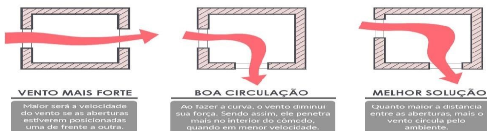
Figura 5 - Exemplos de ventilação cruzada
